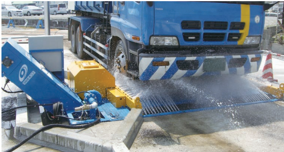
ダブルタイヤを高圧スプレー噴射水で洗浄します。
