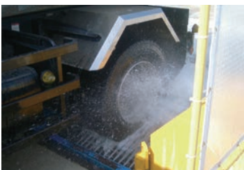
ダブルタイヤを高圧スプレー噴射水で洗浄します。
