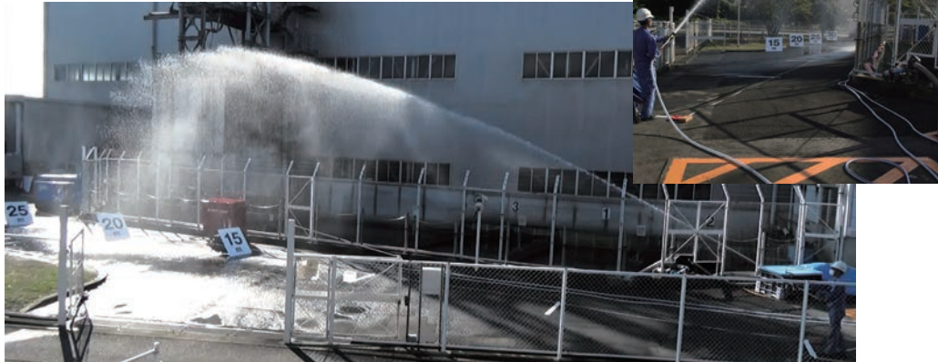
放水飛距離 約25m(水平方向)
